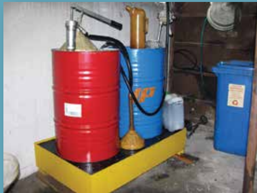
Stoccaggio di oli per le manutenzioni
